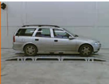
Dieser Rampentyp findet Verwendung bei Wartungsarbeiten oder der Reinigung von Fahrzeugen wie Rasentraktoren, Staplern, Kleintransportern und bietet eine kostengünstige Alternative zu einer Grube oder einer Hebebühne.
