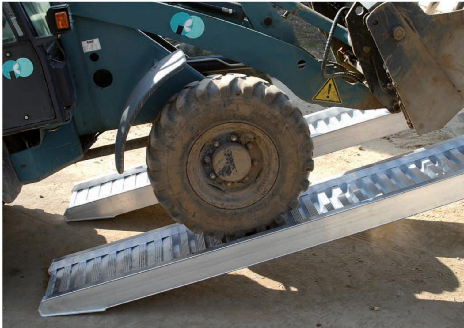
Diese Rampen sind geeignet für die Verladung von leichten bis mittelschweren Fahrzeugen wie Baumaschinen, Gartengeräten oder Rasentraktoren, die mit Luftbereifung oder Gummiketten ausgerüstet sind. Die Fahrfläche ist im unteren Bereich verstärkt, was die Lebensdauer der Schienen erheblich verlängert.
