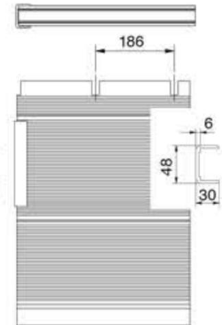
Mit dem überfahrbaren Rückladen aus Aluminium wird eine Verbindung zwischen Rampe und Fahrzeug geschaffen. Der überfahrbare Rückladen ist Bordwand und Überfahrbrücke in einem Element. Die Oberfläche ist profiliert, alternativ mit einem Korundbelag beschichtet oder eloxiert lieferbar.
