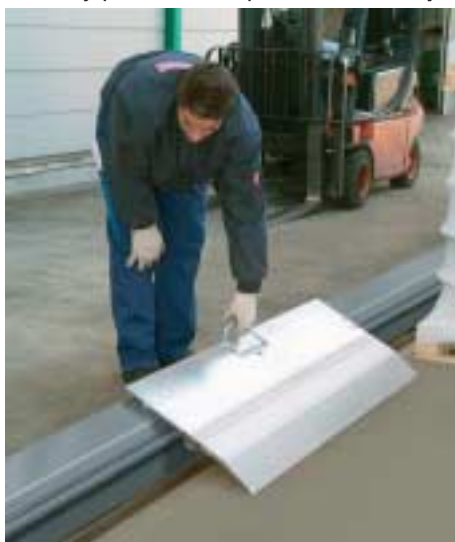
Přední hranu položte na vagón a koncový profil vložte zpět do vodící lišty.
