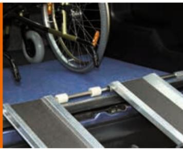
Die ALTEC-Auffahrhilfen RAS-W aus Aluminium sind ein sicheres und schnelles Hilfsmittel für Betreuer. Die Schienen laufen kugelgelagert auf einer Stahlwelle, die fest im Fahrzeug montiert wird. Während der Fahrt sind die Schienen zusammengeklappt und werden stehend in einer Halterung gesichert. Die Fahrfläche ist mit einem rutschsicheren Korundbelag beschichtet.
