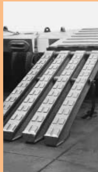
Různé vložky kolových prohlubní pro podvalníkové návěsy
