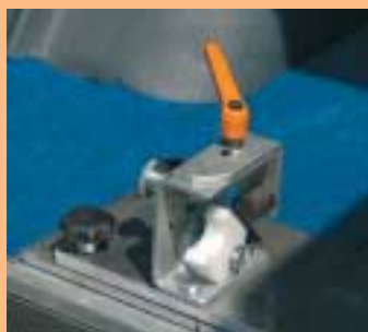
Zajišťovací zámek k aretaci rampy ve vnitřním prostoru.
